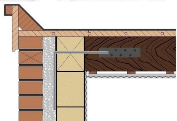
Fig. 14: Ventilatie van het platte dak is dicht geblazen door isolatiemateriaal
