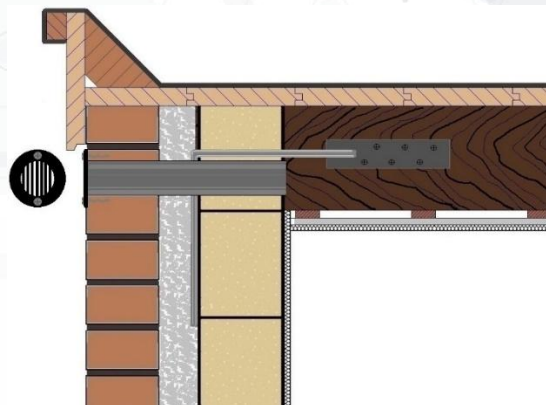
Fig. 15: Ventilatie van het platte dak is hersteld middels een ventilatiekoker
